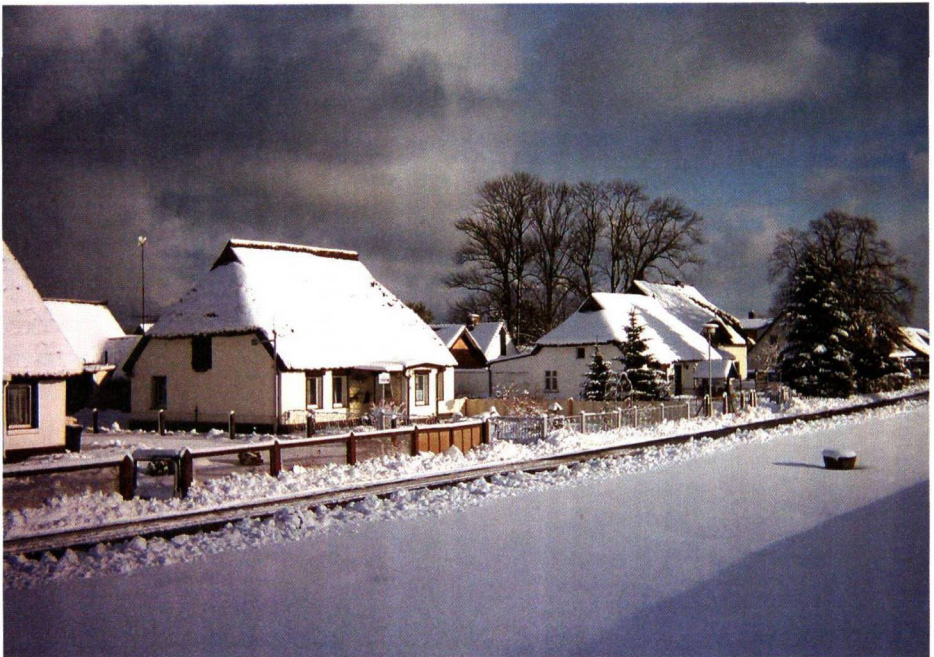
Häuser der Peenestraße mit Krüppelwalmdach
